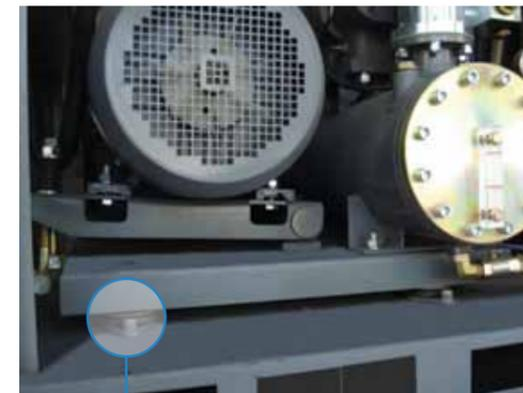
La unidad compresora, el recipiente de lubricante y el motor de accionamiento se encuentran montados sobre una base común sujeta a la estructura de la cabina mediante soportes antivibratorios.
